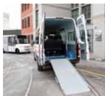
Volkswagen Crafter kombi 35 2.0 TDI 100 kW je prirejen posebej za potrebe prevozov gibalno oviranih oseb.
