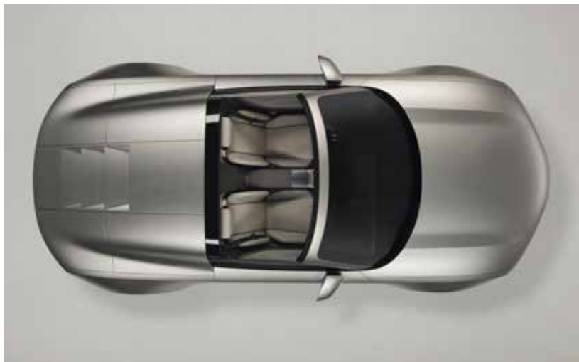
Audi se je prvič pri roadsterju odločil za električno pomično trdo streho. Sestavljata jo dva strešna elementa, ki ohranjata monolitno obliko vozila in hkrati omogočata užitek v vožnji z odprto streho.
