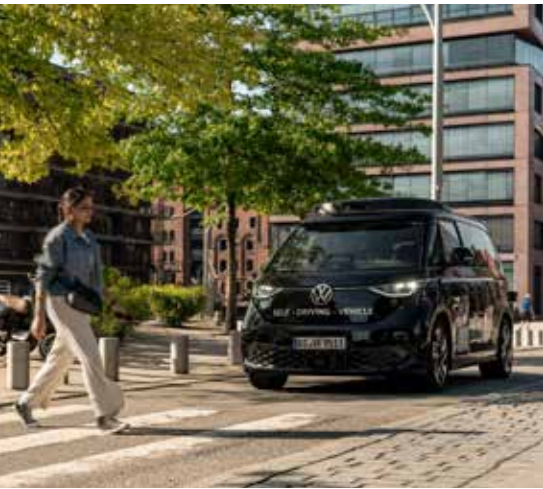
ID. Buzz AD je opremljen s kar 27 senzorji, med njimi je 13 kamer, 9 lidarjev in 5 radarjev, ki vozilu omogočajo popolno 360-stopinjsko zaznavo okolice.
